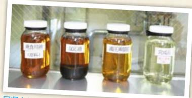
回収された廃食用油は化学処理を施してバイオ燃料へ
