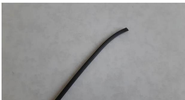
網戸の押えゴムが切れているところからゴムをはずし、古い網を取り除きます。取り除いたら、溝、車輪などに付いている汚れをブラシなどを使い取り除きます。押えゴムは、網戸によってサイズが違うので購入前にサイズを測るか一部を切り取り販売店でサイズを確認してください。
