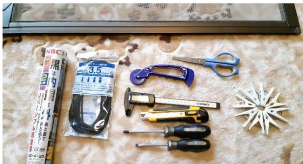
新品の網、押えゴム、ワンタッチローラー、はさみ、カッター、+ドライバー、洗濯ばさみやクリップ、定規、ブラシなど
